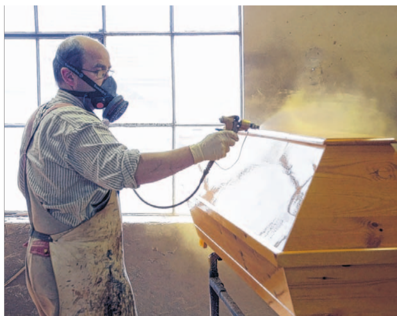
In der eigenen Lackiererei können die Särge mit fünf bis sieben Schichten in Hochglanz lackiert werden.
