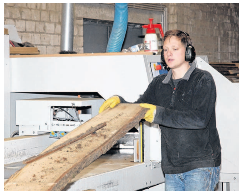
Eine Kappsäge kappt das Holz im ersten Schritt auf die Längen für Deckbretter, Seiten-, Fuß- und Kopfstücke.
